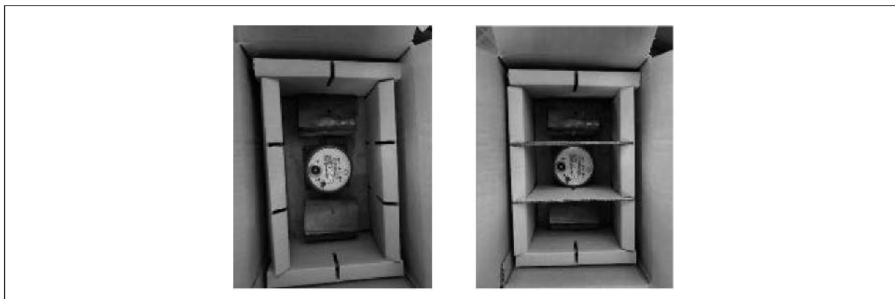
Tavola 7 - Posizionamento del decelerometro nel collo
